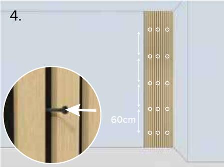
4. Colocar el panel acústico en la pared y clavarlo.
