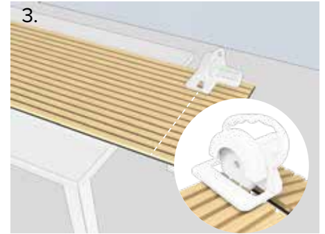
3. Coupez le panneau acoustique selon la mesure du mur
